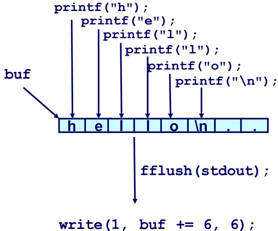
Il buffer è “flushato” verso l'output fd con “\n” oppure **fflush()**
