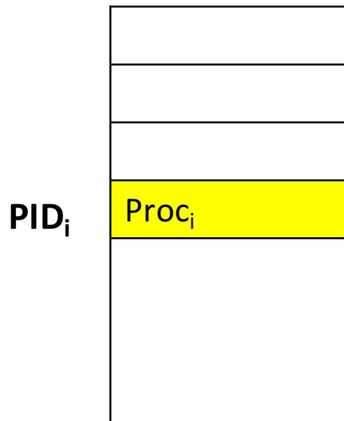
Le process structure sono contenute nella process table, che contiene un elemento per ogni processo.
