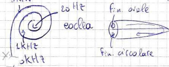
l'onda che si propaga nella eodola cambia ampiezza nello spazio ma ha massimo in un punto per poi andare a zero. Correlazione tra f. e pto di max risposta
